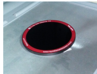
(b) Fantôme TOR utilisé pour les tests d'imagerie
