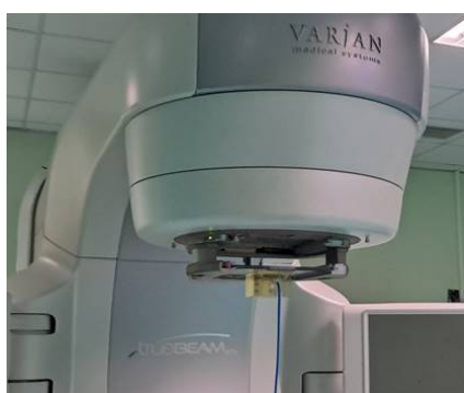
FIGURE 2.1 – Plaque utilisée pour le contrôle quotidien (TOP)
