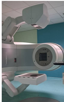
(a) Accélérateur linéaire avec le fantôme TOR placé
