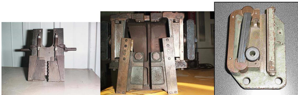
FIGURE 1.18 – Différents types de parachutes
