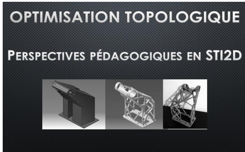
Figure III.2 : Suppression des matériaux inutiles par optimisation [36].
