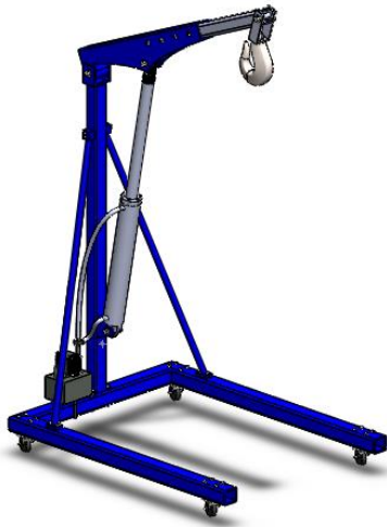
Figure III.4 : Grue d'atelier avant simplification.
