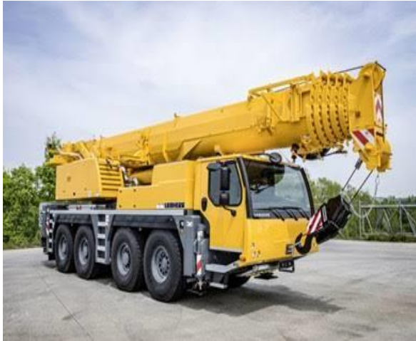
Figure I.2 : Grue mobile sur roues [4].
