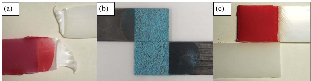
Figure II. 9 Modes de rupture des joints adhésifs (a) rupture d'un des adhérents (b) rupture cohésive à l'intérieur de l'adhésif (c) rupture de l'adhésif à l'interface entre l'adhérent et l'adhésif [17].
