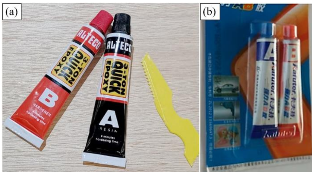
Figure III. 2 Adhésifs utilisées (a) époxy (b) acrylique modifié
