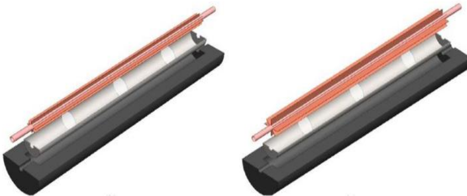
Figure II-5: Vue 3D des échangeurs de chaleur contenant MCP avec ailettes de 13 et 26 mm.[18].
