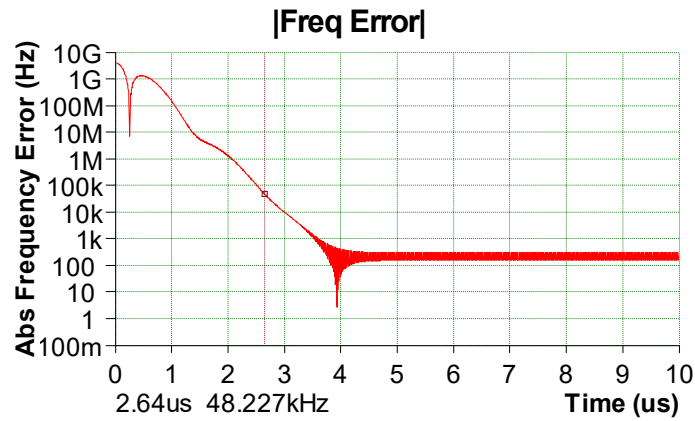
Figure III.36. Évolution de la fréquence d'erreur lors du processus de verrouillage de la PLL.
