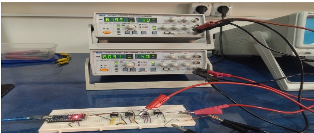
Figure III. 28: Montage de Test et Mesure du Signal pour le Mini Oscilloscope BF Numérique
