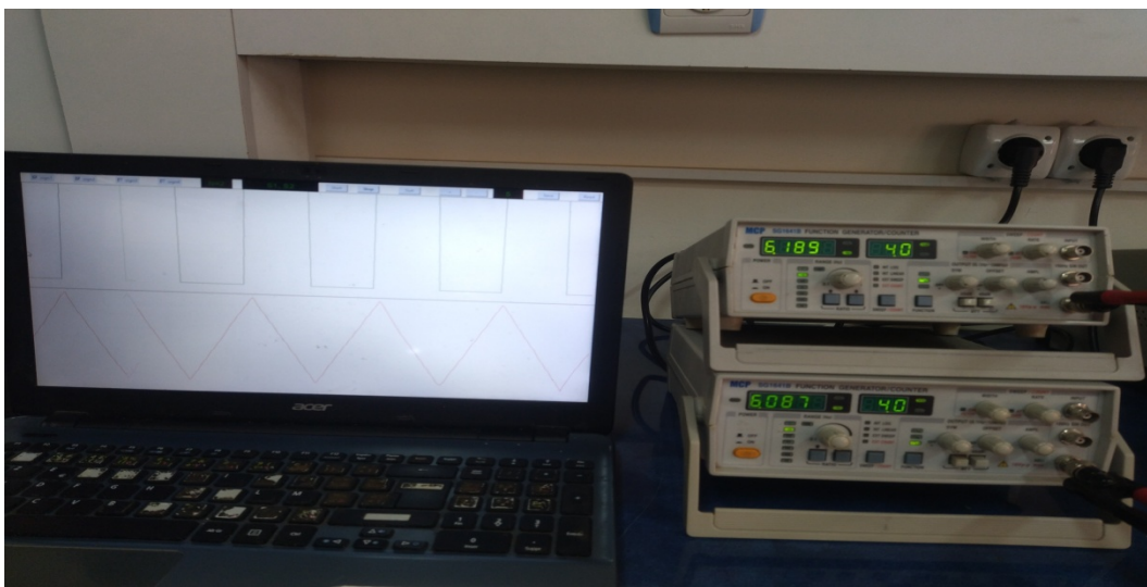
Figure III. 29: Affichage des Signaux Carré et Triangle sur Interface Tkinter à 6189 Hz et 6087 Hz
