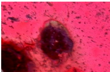
Fig.4 : Corrosion par pique
