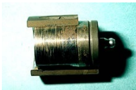
Fig.7 : Corrosion avec frottement
