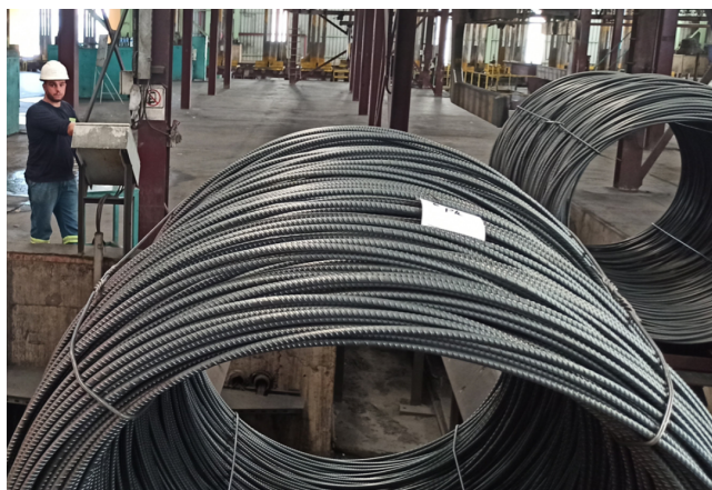
FIGURE I.4 – Rond d'armature en bobine du tosyali
