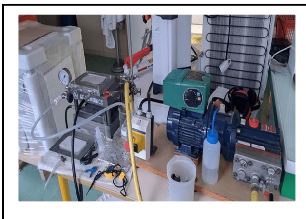
Figure 28. Pilote de filtration GE Osmonics, de configuration UF/NF à l'échelle laboratoire.
