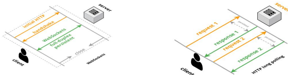
Figure 58: Processus de Communication Web Socket : Handshake et Connexion Persistante et Communication Client-Serveur avec HTTP Long Polling
