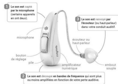
Figure 51:fonctionnement des appareils auditives
