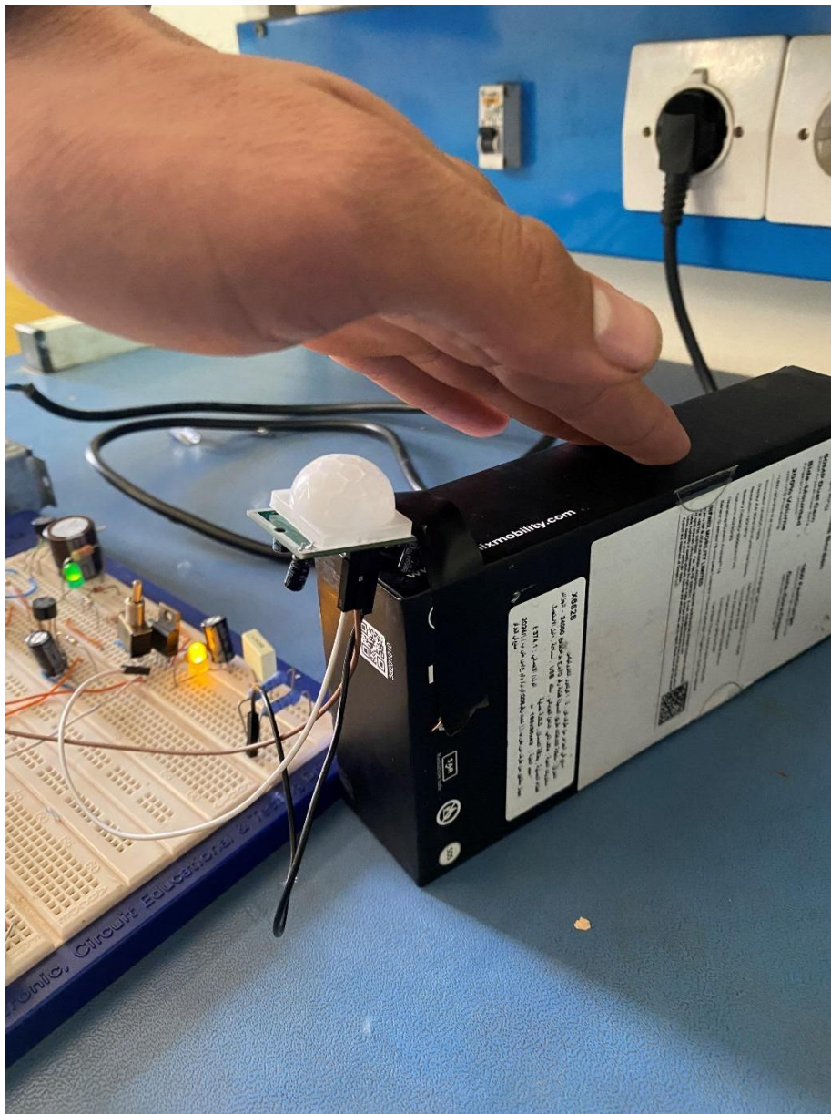
Figure III-14 : État de détection – Passage de la main devant le capteur PIR (DM2)
