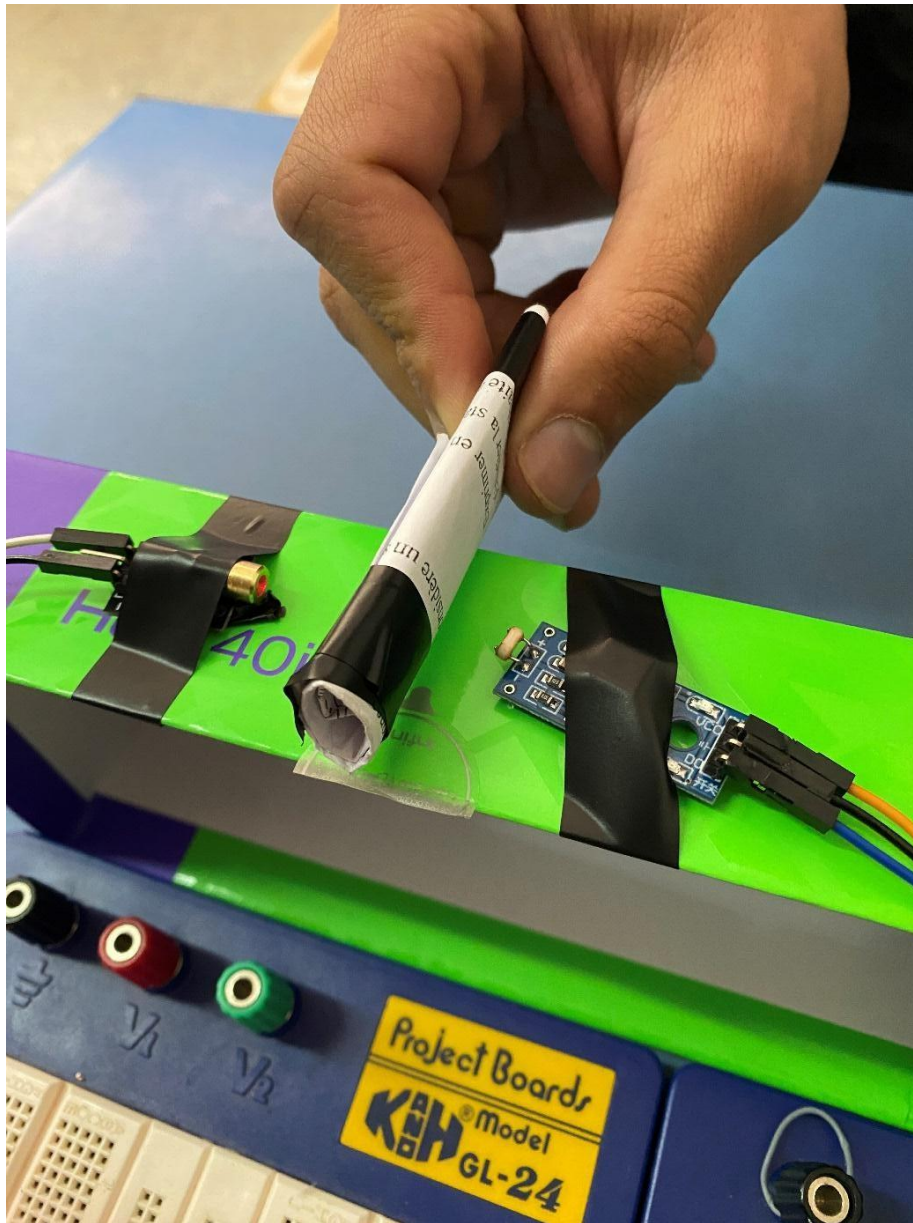
Figure III-16 : État de détection – Interruption du faisceau laser entre LDR et laser (DM1).
