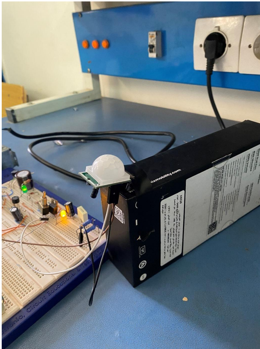
Figure III-13 : Image d'un état de repos – Aucun mouvement détecté par le capteur PIR (DM2).
