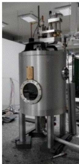
Figure 6 : la forme réelle de du réacteur et la chambre a arc.
