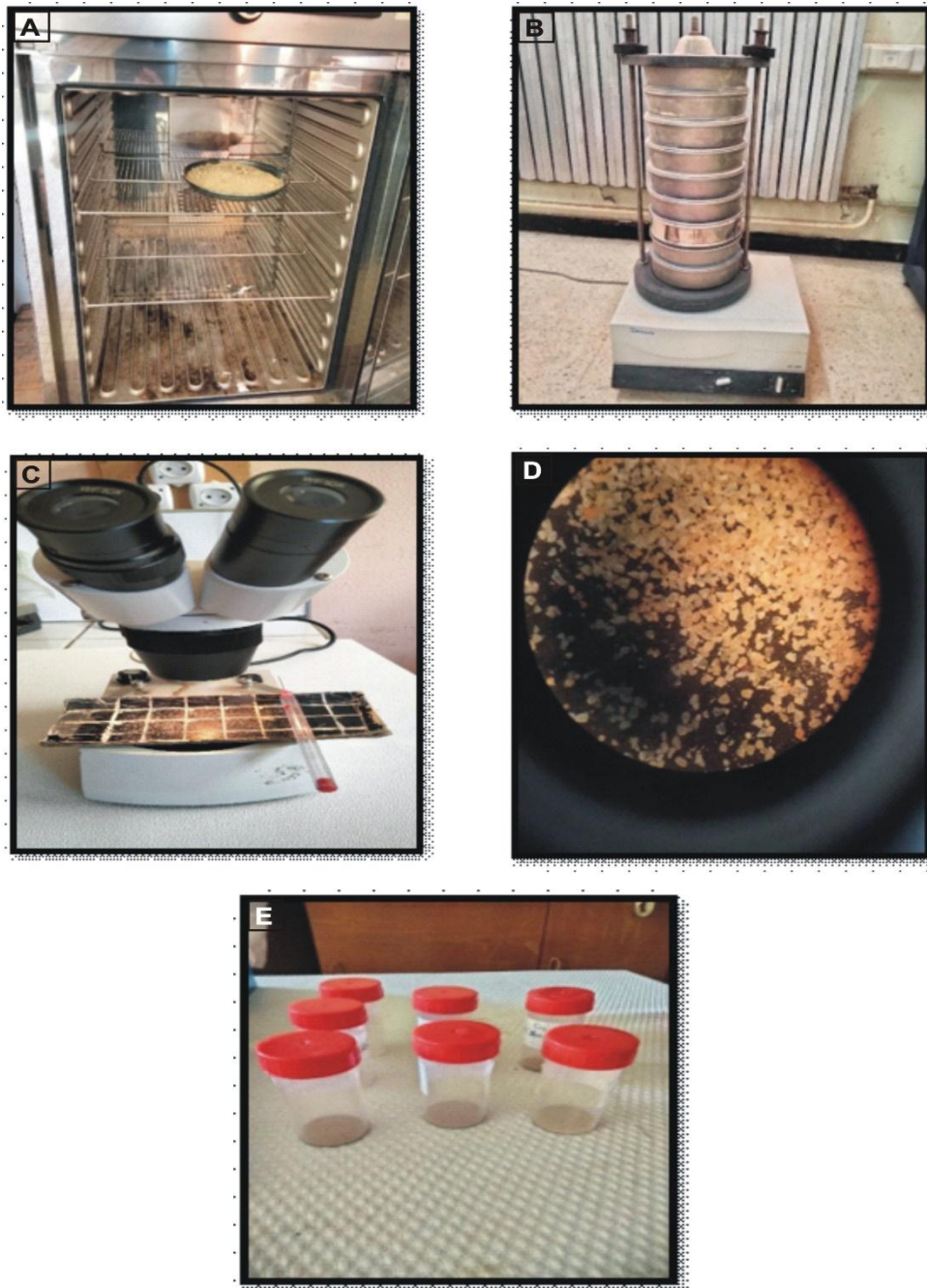
Fig. 06 : Protocole méthodologique de l'analyse granulométrique et morphoscopique : illustrations des différentes étapes opératoires.
