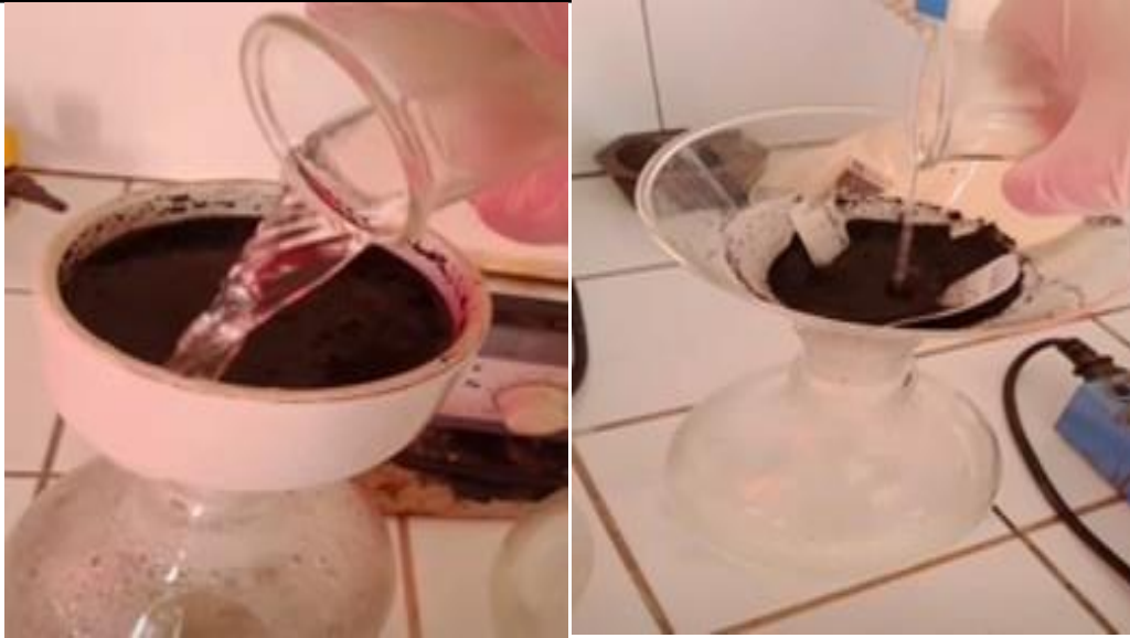
FIGURE II.4 : Lavage par l'eau distillée chaude.
