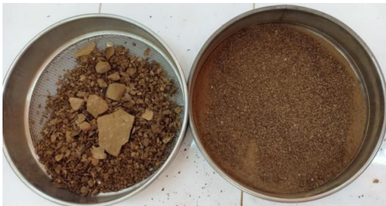
Photo 13: Séparation des éléments grossiers et la terre fine(original).
