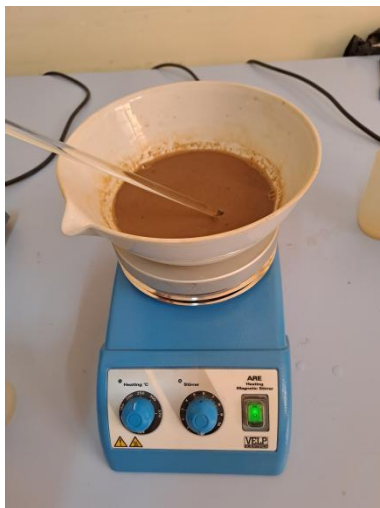
Photo 14: Dispersion du mélange par la chaleur(original).
