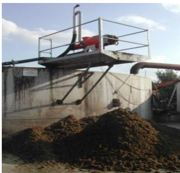
Figure 1.20 : Élimination des digestats par centrifuge [61]
