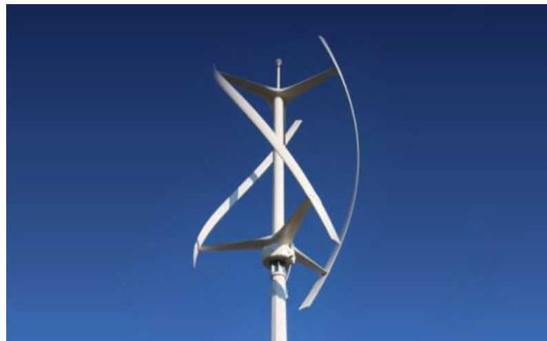
Figure I.6 : Éolienne à axe verticale de type Darrieus [17]
