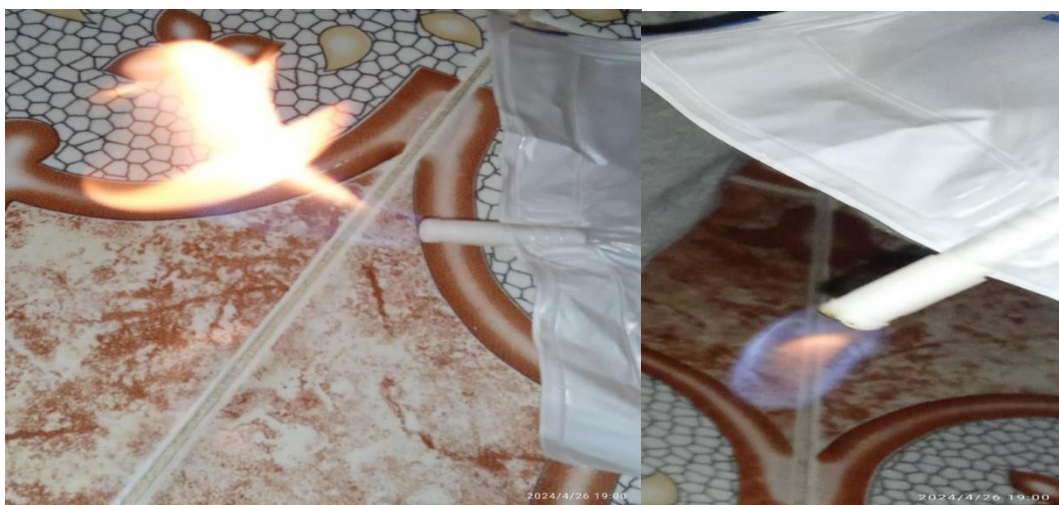
Figure 3.11 : Test d'inflammabilité dans le deuxième digesteur
