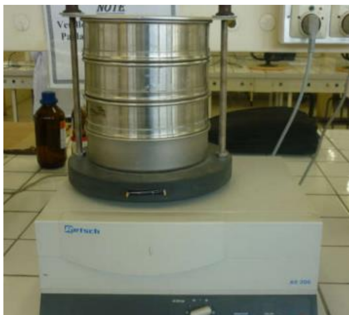
Figure II.4 : Tamis vibreur électrique utilisé pour l'analyse granulométrique
