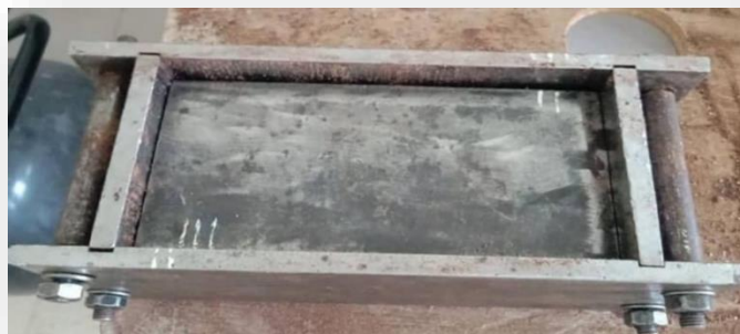
figure 3.10: Le moule utilisé pour confection des briques[3]
