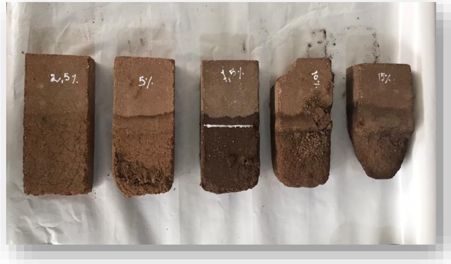
figure 3.20: état des briques après l'essai de tenue à l'eau par immersion.
