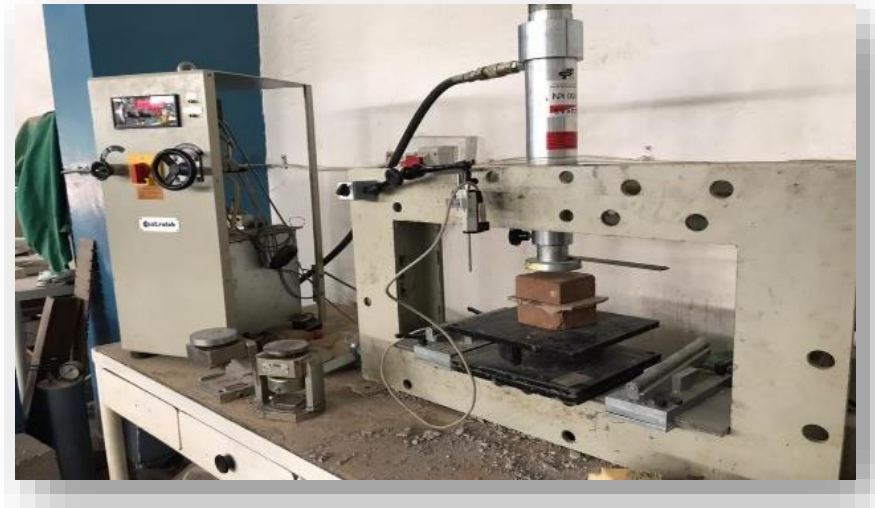
figure 3.14: essai de compression simple d'une brique en terre comprimée.
