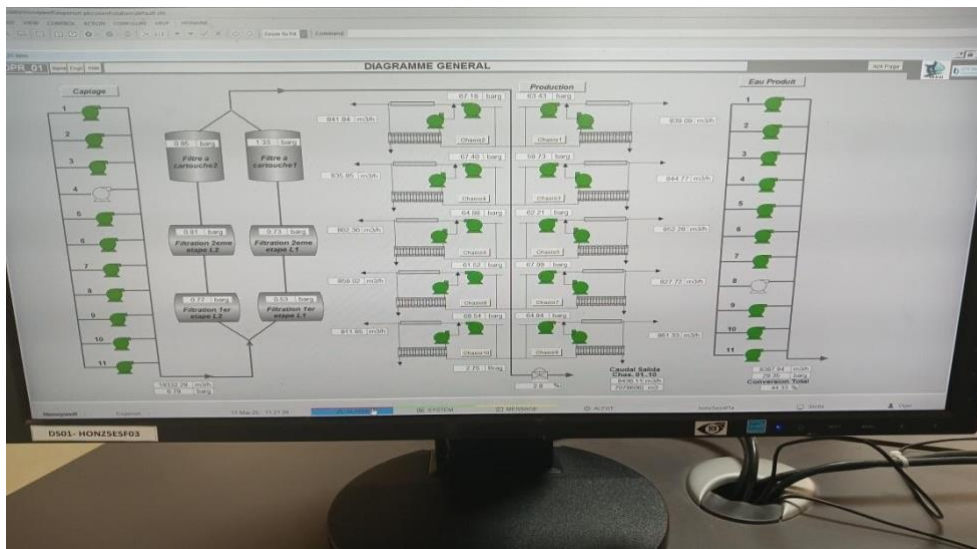
Figure 50 : Diagramme complet du processus de dessalement affiché à la salle de contrôle(origine ;2025)
