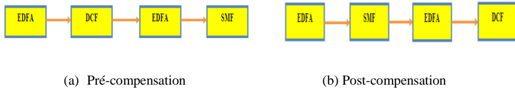
Figure IV.10. Les configurations de compensation de la dispersion chromatique
