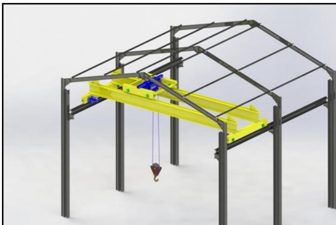
Figure IV. 1 : Schéma 3D du pont roulant.
