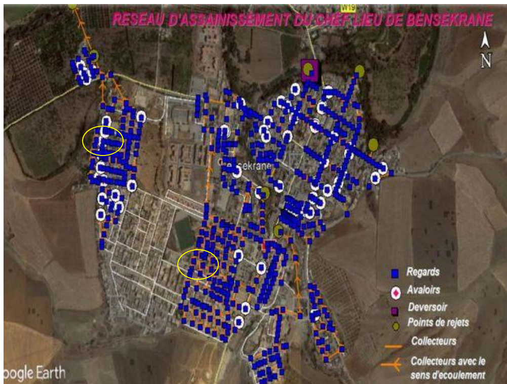
Figure IV.14. Les points noirs du réseau d'assainissement.
