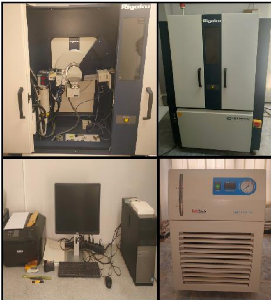
Figure II. 8 : Photos du Diffractomètre X Ultima IV, Itm2036E302.
