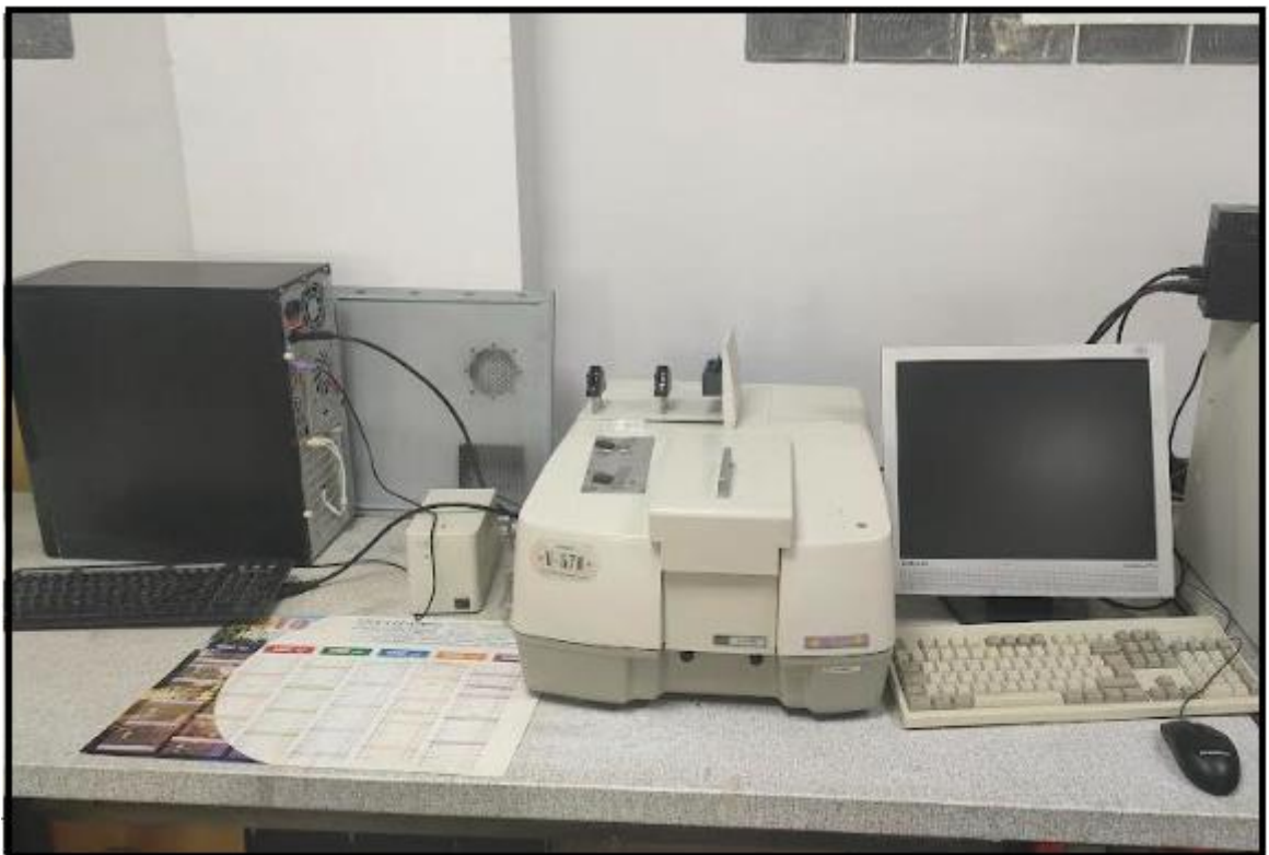
Figure II. 12 : Photos du Spectrophotomètre de type Jasco V-570.
