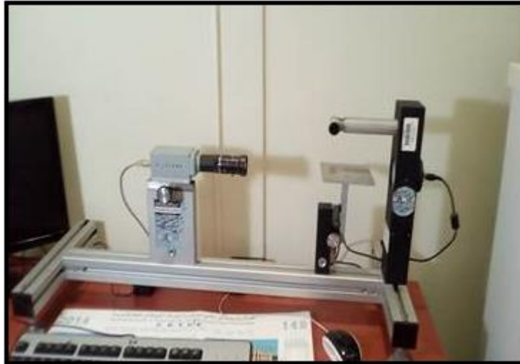
Figure II. 13 : Photos du système de caractérisation d'angle de contact.
