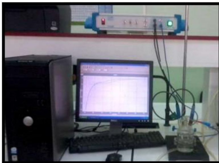
Figure II. 1 : Matériel d'élaboration à trois électrodes.
