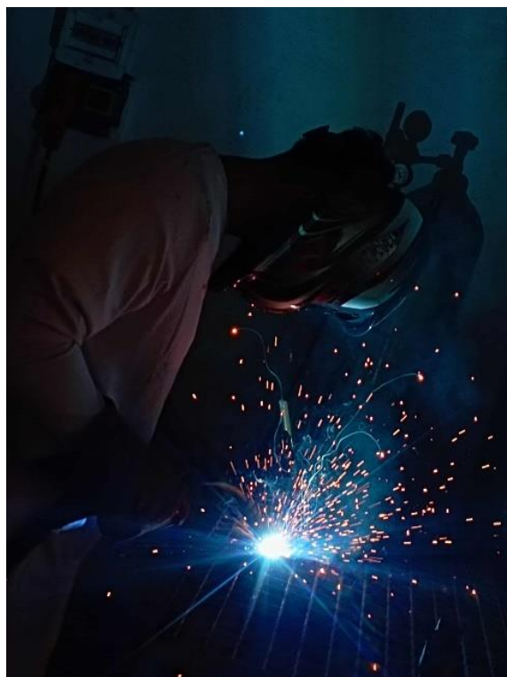
Figure I. 2. Soudage par procédé MIG/MAG
