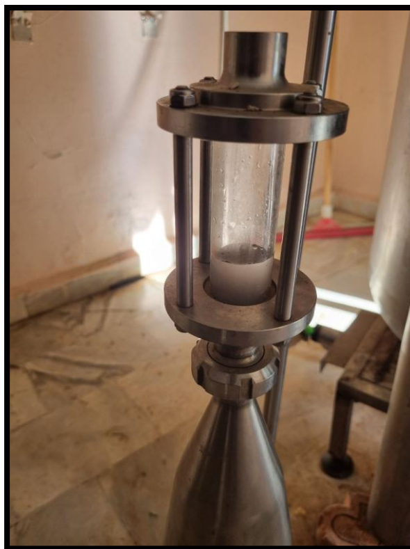
Figure 108. Décanteur contenant l'huile essentielle extraite
