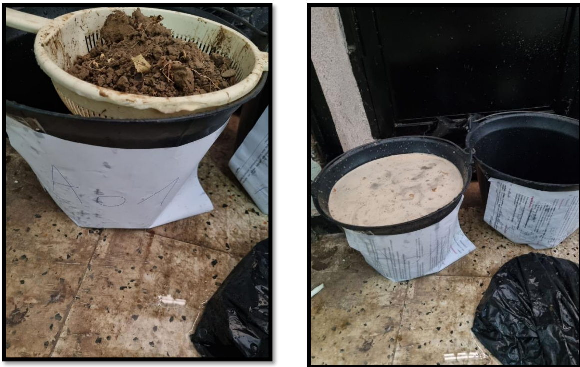
Figure 100. Lavage et élimination des éléments grossiers par la passoire
