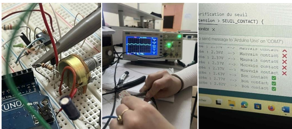
Figure 3.17. Résultats expérimentaux de la mesure d'impédance corporelle obtenus en laboratoire
