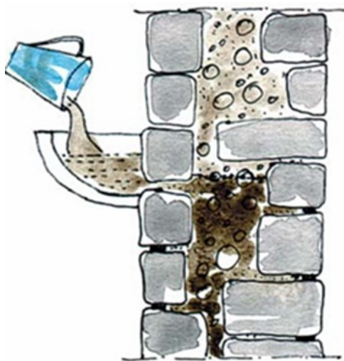
Figure : 1ère étape de consolidation par coulis de chaux
