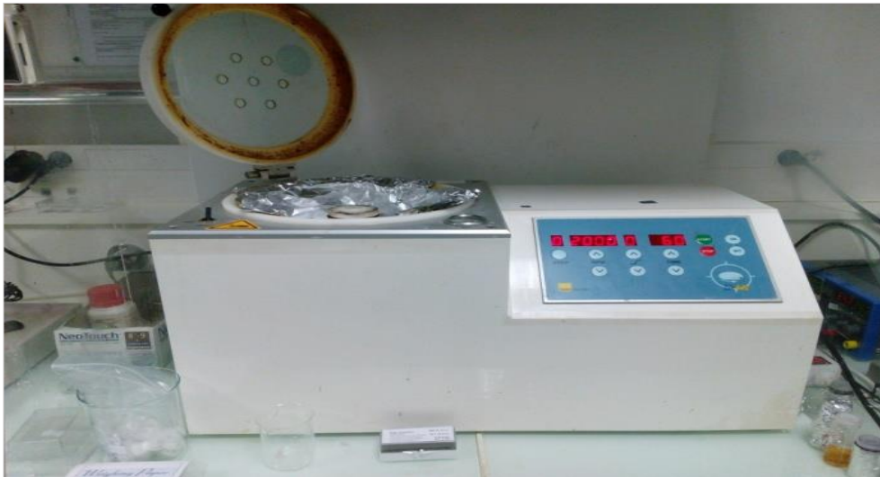
Figure II.10 : Photographie de la tournette (spin-coater) de la marque SÜSS.
