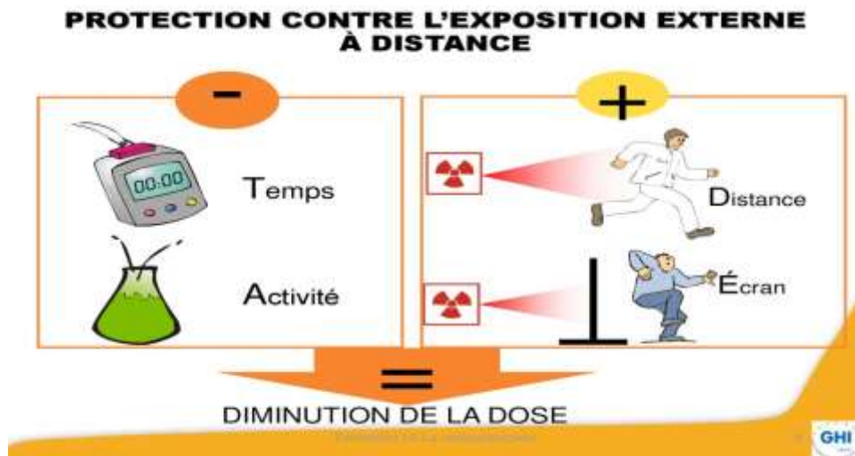
Figure III.3 : Protection contre l'exposition externe
