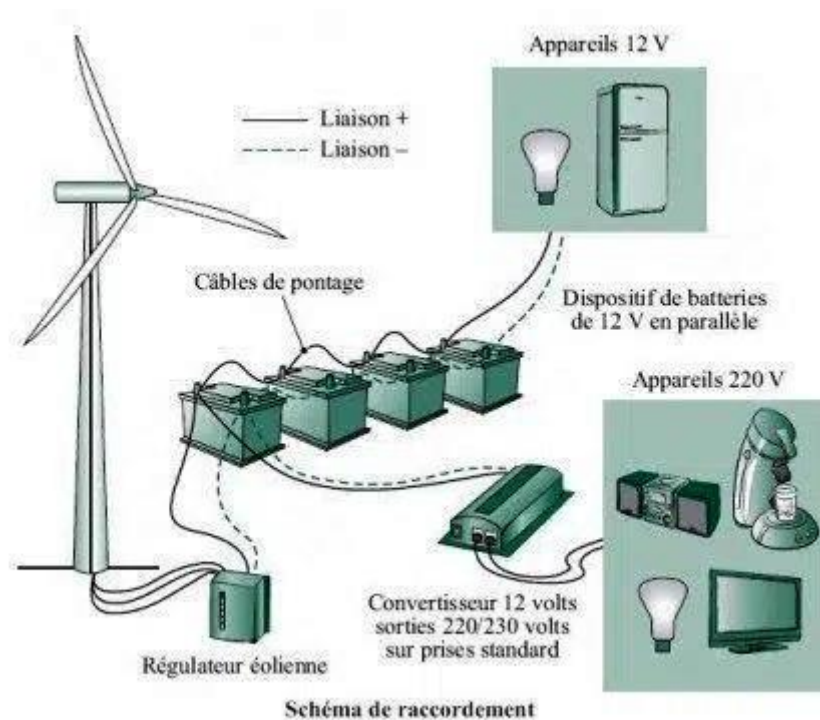
Figure I.20: Raccordement d'une petite éolienne au réseau domestique (eolienne-domestique 2022).
