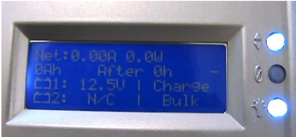
Figure III.5: L'afficheur à cristaux liquides du régulateur de charge.
