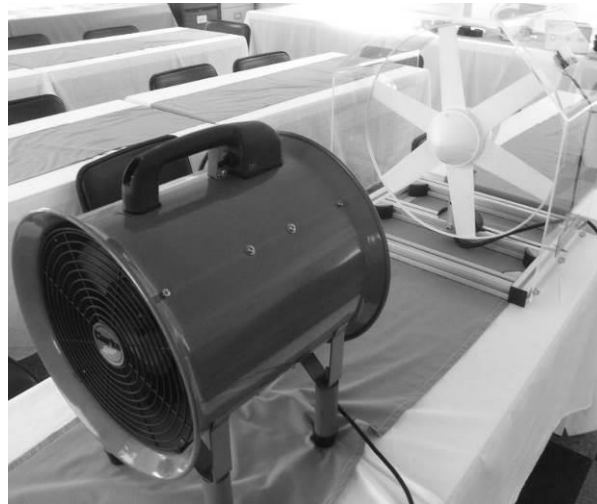
Figure III.6: Disposition expérimentale pour la mini-éolienne.
