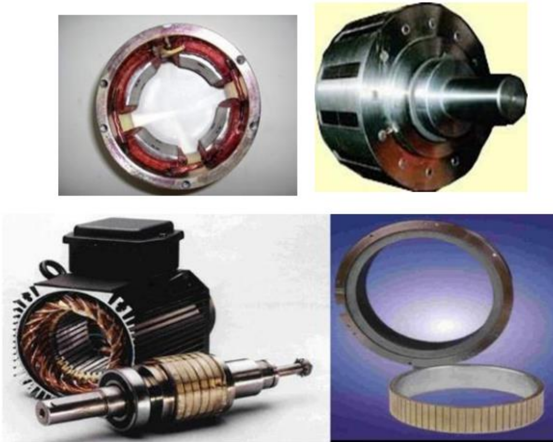
Figure III.28: Photographie d'une machine synchrone à aimant permanents (Benbrahim 2009).
