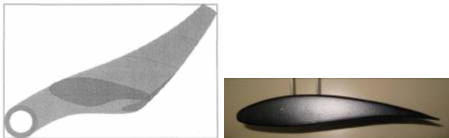
Figure I.6: Pale de micro-éolienne et son profil (Feld 2010).
