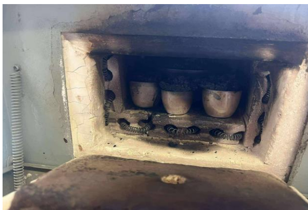
(a) Creusets contenant le charbon après carbonisation
