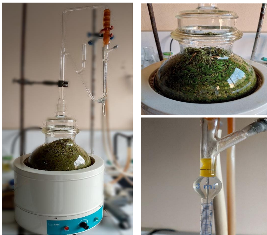
Figure 9 : appareillage de l'hydrodistillation (images personnelles)
