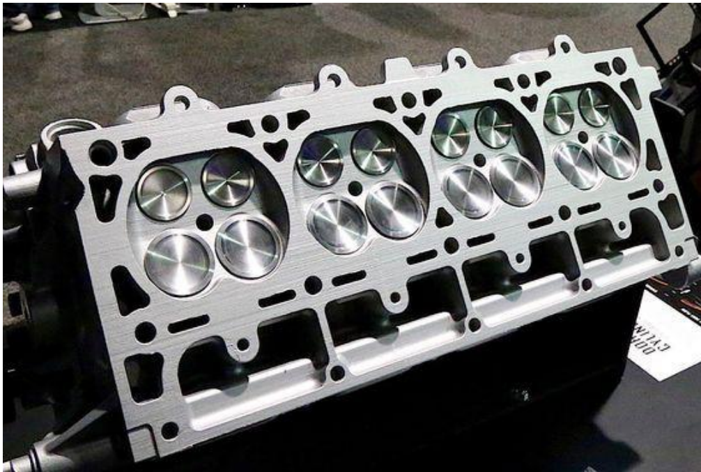
Fig. I. 12 Composant moteur (culasse) fabriqué par usinage CN 5 axes [27].
