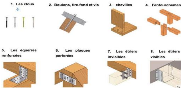
Figure 18: Système d'assemblage pour ossature en bois
