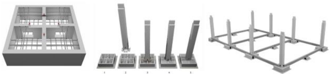
Figure 147: Etapes de production des fondations préfabriquées
