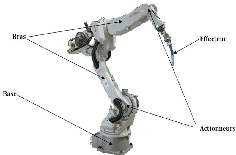
Figure 6 : les élément d'un robot manipulateur
