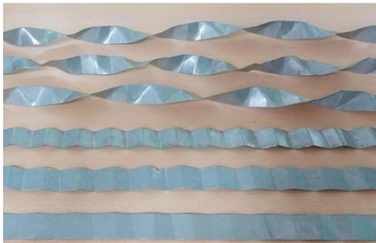
Figure II.5. Photographies des rubans trapézoïdaux et trapézoïdaux torsadés [53]
