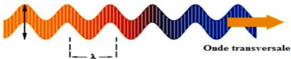
Figure1.2 : Représentation de l'onde mécanique transversale : vibration perpendiculaire à la propagation [5]
