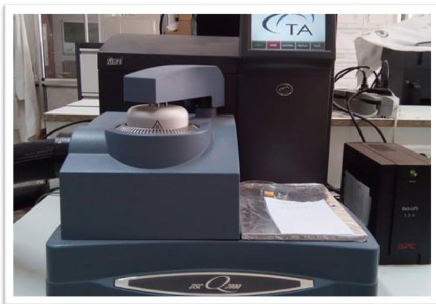
Figure II. 6 : Illustration de l'appareillage de DSC.
