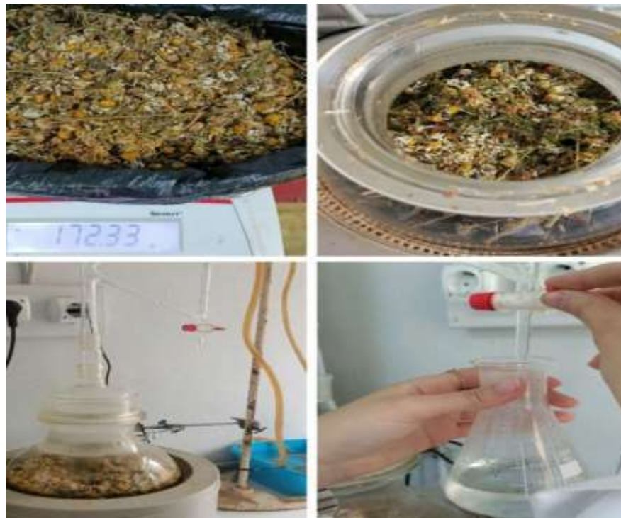
FIGURE 09: Extraction d'hydrolat de camomille matricaire avec hydrodistillateur de type clevenger ( photo originale 2025 )
