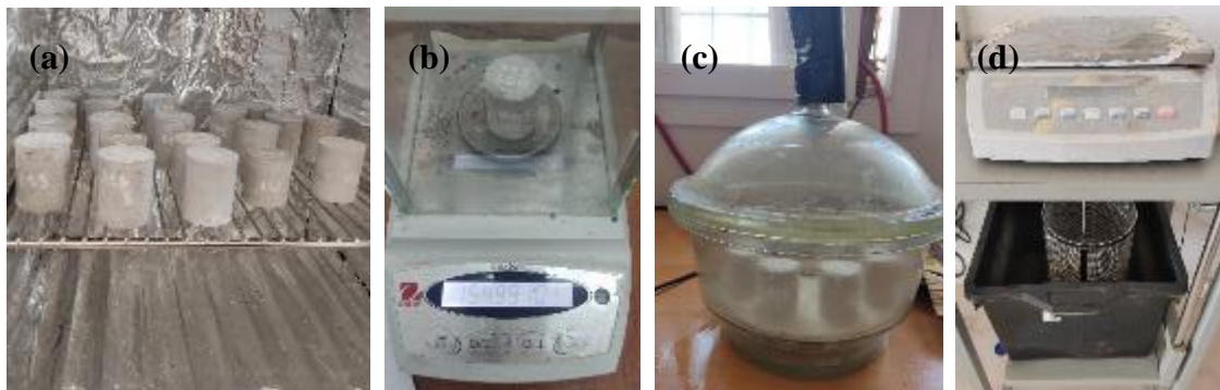
Figure III.14 : Mesure de la porosité accessible à l'eau : (a) étuvage des échantillons, (b) pesée de la masse sèche, (c) saturation sous vide et (d) pesée hydrostatique.
