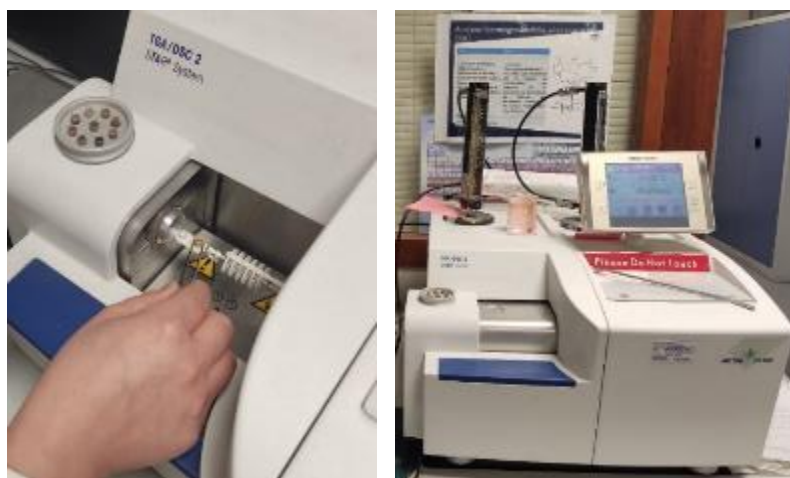
Figure III.17 : Dispositif de l'essai d'analyse thermogravimétrique.
