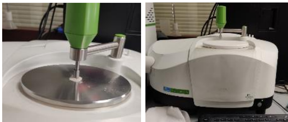
Figure III.18 : Dispositif de l'essai d'IRTF.
