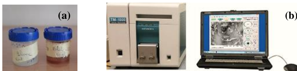
Figure III.16 : (a) Echantillons d'acier immergés dans du SSPB avec 0,5M NaCl et (b) microscope électronique à balayage (Hitachi - TM1000).
