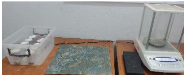
Figure III.15 : Mesure de l'absorption capillaire.
