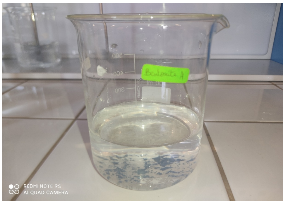
FIG. 3.14 : Eau traitée par coagulation-floculation en utilisant le poly(AM-CO- 4VP).
