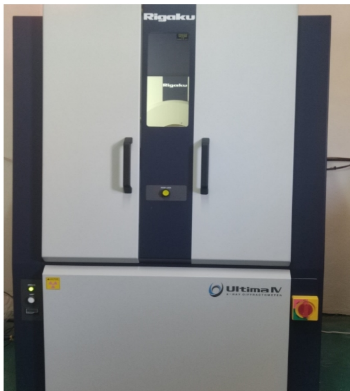
FIG. 2.6 : L'appareil de la diffraction des rayons X de type RIGAKU ULTIMA-IV(LAÉPO).
