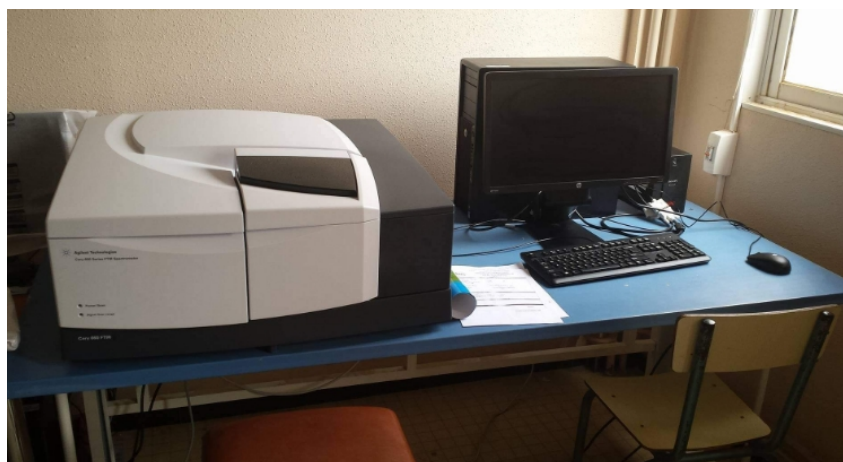
FIG. 2.2 : L'appareil d' infrarouge "CARY 600 SEIES FTIR" (LAEPO).
