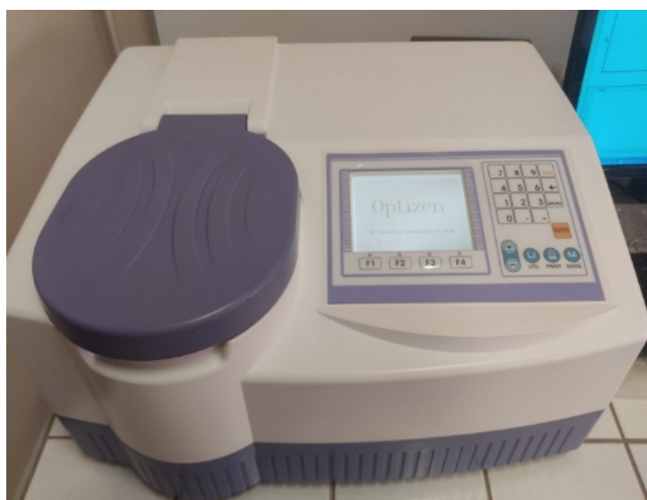
FIG. 2.5 : équipement UV "OPTIZEN 2120 UV-Visible" (LAEPO).
