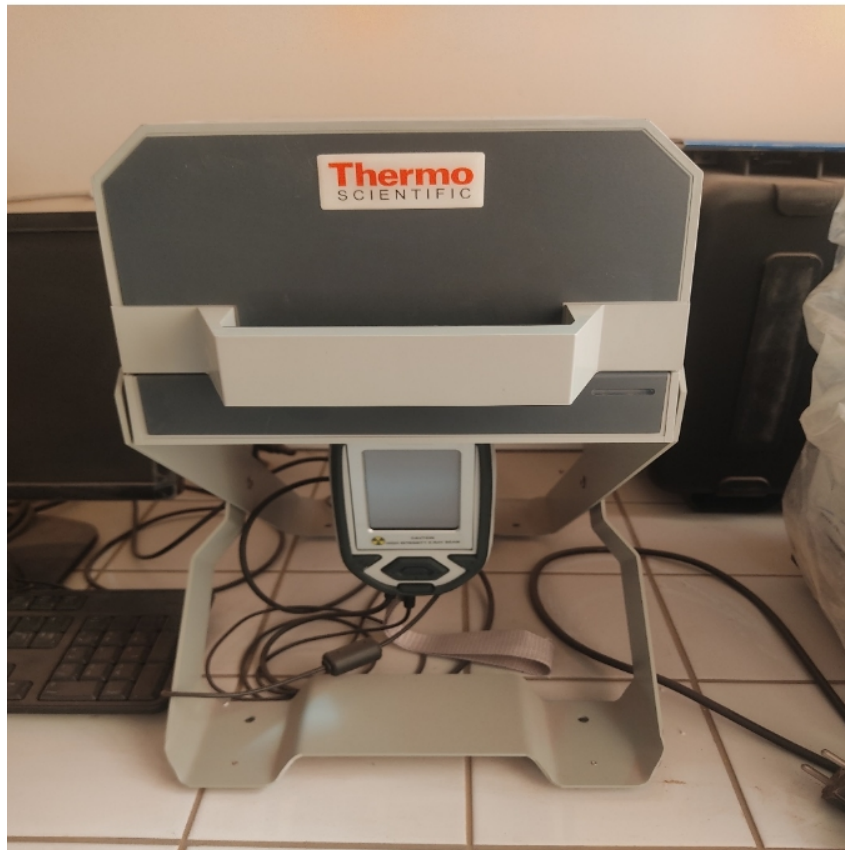
FIG. 2.7 : L'appareil XRF de type Thermo scientifique Niton XL3t(LAEPO).
