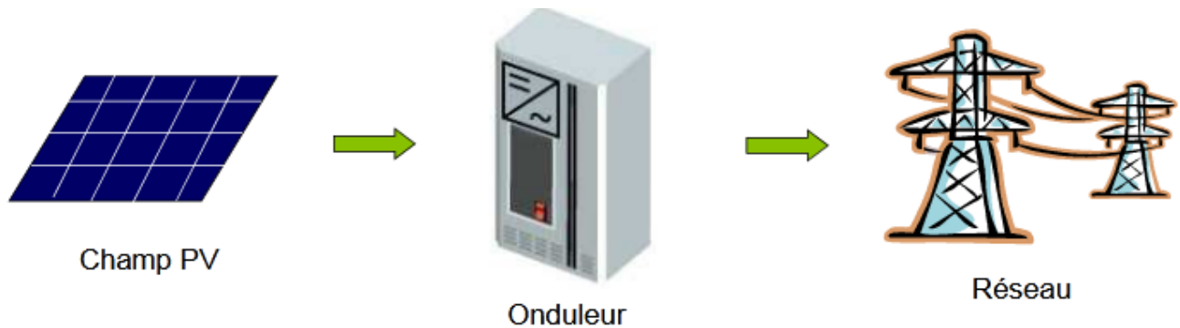
Figure II.9. Principe de fonctionnement des onduleurs [31].
