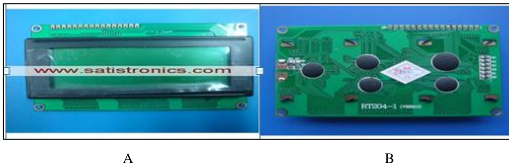
Figure 2.26 : LCD 20*4 (A :face antérieure, B :face postérieure)
