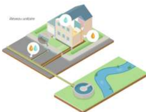
Figure 25 Système d'assainissement type séparatif
