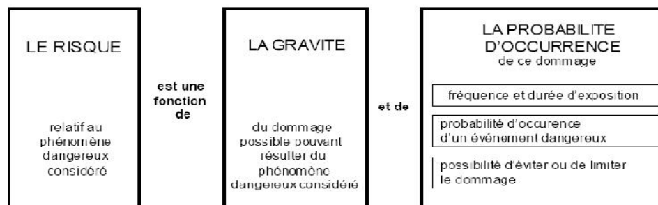
Fig.4-68 Les éléments du risque selon la norme NF EN 1050.
