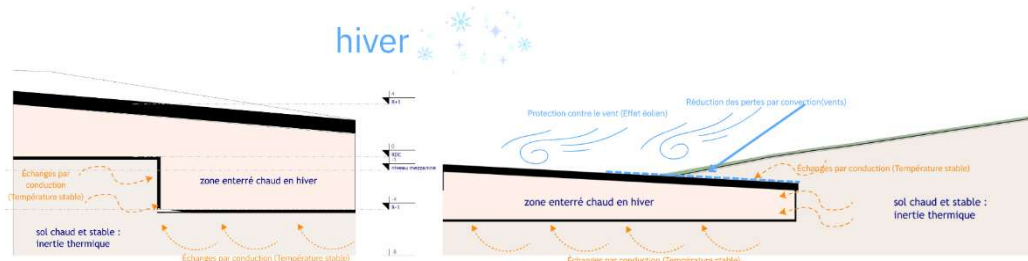
Figure 35 Diagramme des flux thermiques passifs en période hivernale (Zone semi-enterrée). Source les auteurs
