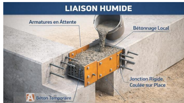
Figure I-21 : Liaison humide entre éléments préfabriqués.
