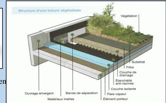
Figure 138: Schéma d'isolation de toiture par la végétation.
