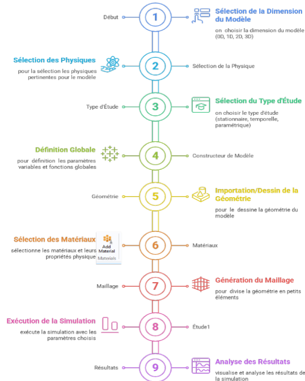
Figure II. 2 - Etapes de modélisation et simulation sous COMSOL Multiphysics [8].
